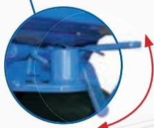
Protection automatique d'attelage du timon. Mécanisme à ressort protégeant le timon contre le décrochement.
