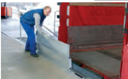
Opérationnel rapidement : Ce pont de chargement adossé, accroché au profilé vissé sur la rampe, se laisse coulisser latéralement.
