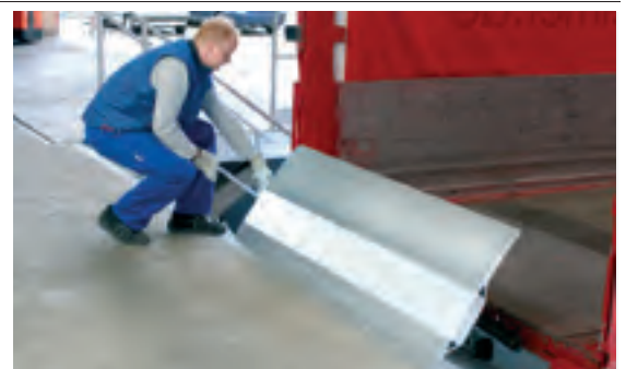
En position verticale, le pont est sécurisé automatiquement - il se laisse déverrouiller et abaisser facilement avec un levier de manoeuvre.
