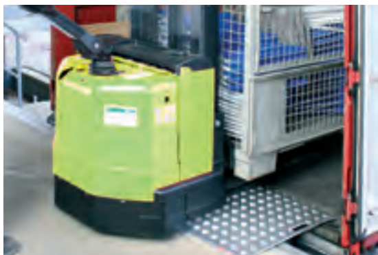
Ces passerelles de chargement peuvent être rangées, sans occuper trop de place, à la réception des marchandises et compensent les dénivellations jusqu'à 100 mm.
