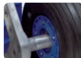
ELARGISSEMENT DE LA VOIE
